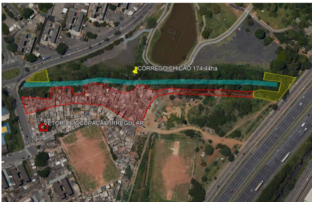
Figura 02 – Trecho de cerca de 400m do Córrego Chicão. Detalhe da margem direita com ocupações subnormais e irregulares em expansão e, em amarelo, áreas de descarte irregular de lixo e entulho.
